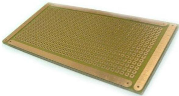
A placa de Fenolite será onde a equipe desenvolvera seu circuito integrado e final. A vantagem do uso de uma dessas é que não há riscos de no momento em que a competição estiver acontecendo soltem fios ou componentes, haja vista que o circuito é pré soldado na plaquinha.
